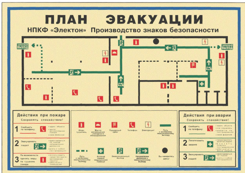
Рис. 1.4. Секционный план эвакуации (фотолюминесцентный) [21]
